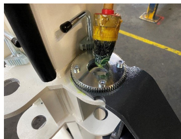
Obere Bohrung einfetten
