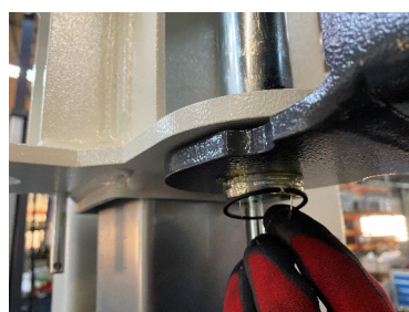
Sicherungsring unten anbringen
