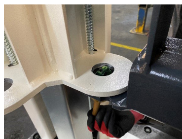
Untere Bohrung einfetten
