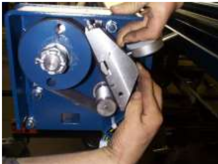
Figure 17 : Positionner l'appareil de mesure sur la courroie
