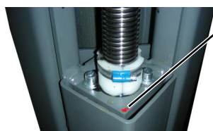
Bild 18: Hubmutterstift mit Siegelack versehen
