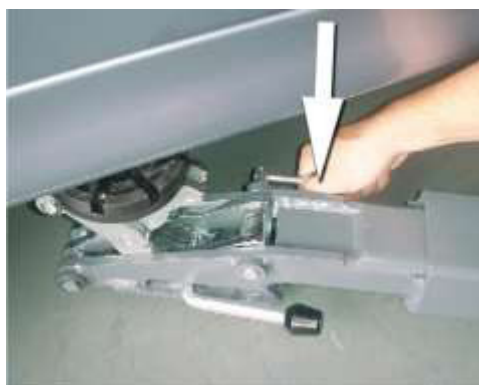
Figura 3: Para desenganchar los platos de elevación se deberá presionar la palanca posterior.
