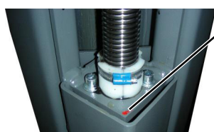
Immagine 18: Applicare dello smalto sigillante sul perno della madrevite di sollevamento
