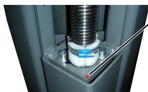
Figura 18: Aplicar lacre al pasador de la tuerca de elevación
