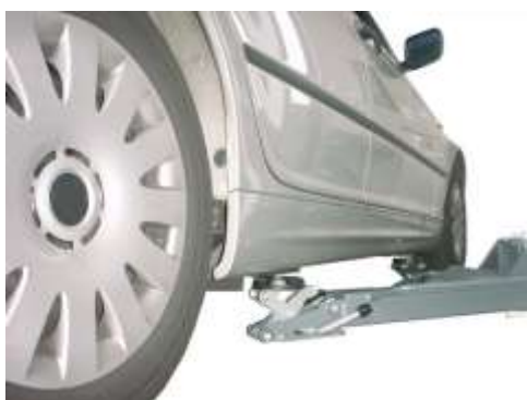
Figura 1: Posicionar los platos portantes debajo de los puntos de elevación solicitados por el fabricante del vehículo.
