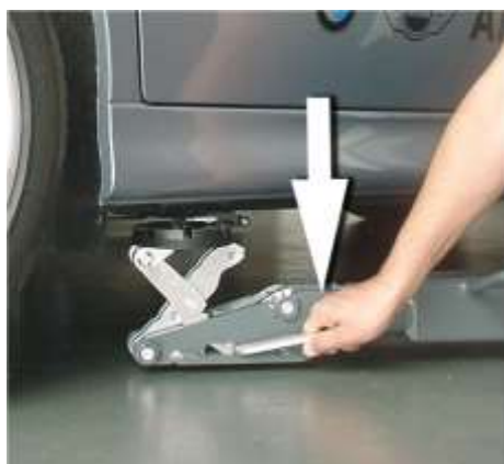
Figura 2: Dado el caso, aplicar los platos portantes en los puntos de elevación presionando la palanca.
