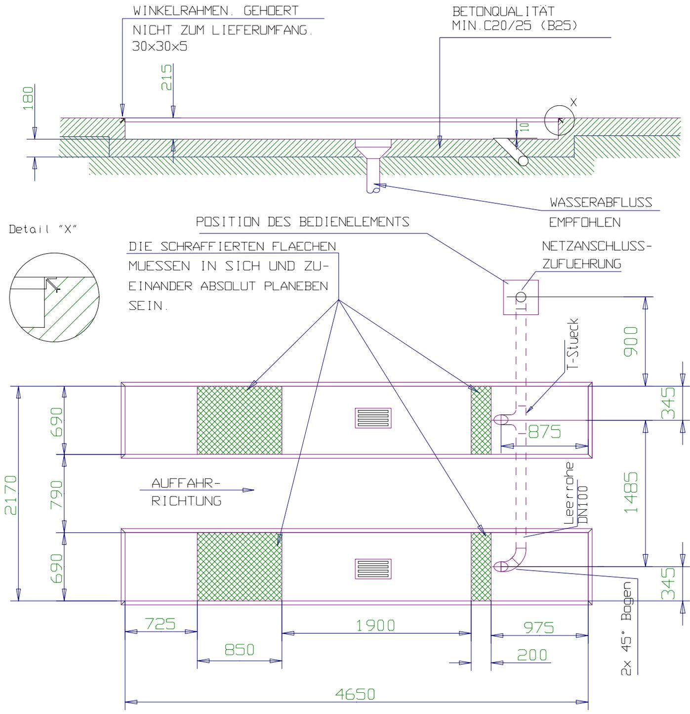
BAUSEITS IST FOLGENDES ANZUBRINGEN: NETZANSCHLUSS 3 /N+PE, 400V, 50Hz, KABELLAENGE CA. 2m
