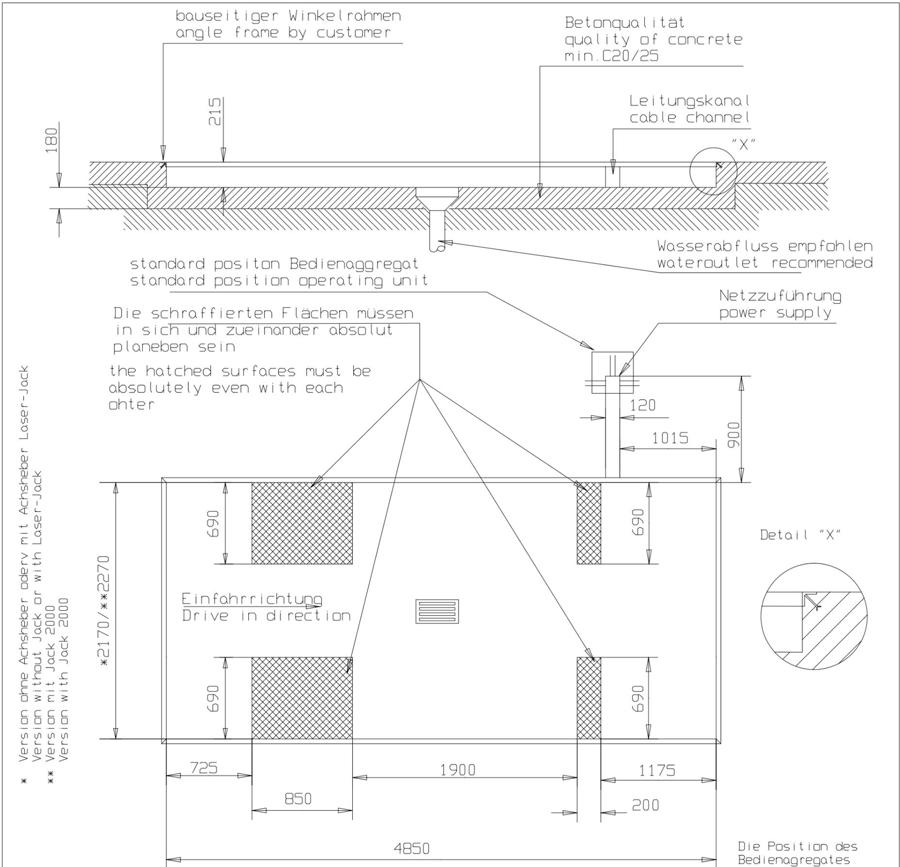
Gültig für die Serienausführung mit Stellplatten und beidseitigen Auffahrklappen
