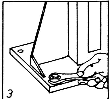
**Achtung:** Nur Dübel, die sich mit dem vorgeschriebenen Moment anziehen lassen, sind geeignet, die nötige Last zuverlässig zu übertragen und die Sicherheit des Hebezeugs zu gewährleisten.
