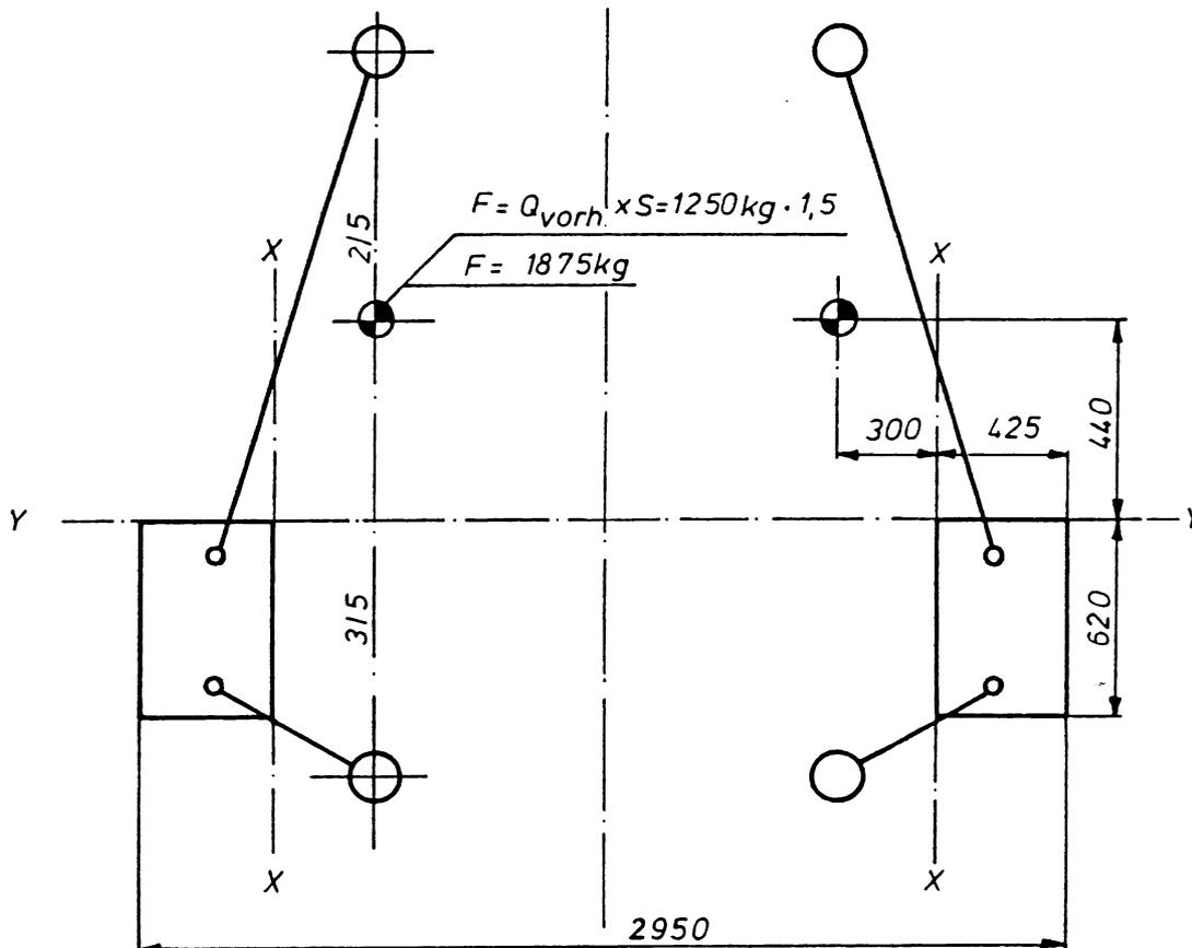
Bevor mit dem Aufstellen der Zweisäulenbühne begonnen wird, muß sicher sein, daß das Fundament die von jeder Hubsäule auf den Boden übertragenen Kräfte und Momente aufnehmen kann.
