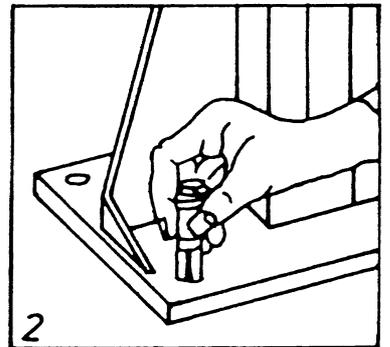
3) Die Dübelmutter ist jetzt mit dem Drehmoment  $M = 80 \text{ Nm}$  anzuziehen, die Hülse spreizt sich zylindrisch und bricht dabei an den Sollbruchstellen auf. Danach ist die überstehende Gewindestange des Dübels entsprechend zu kürzen.
